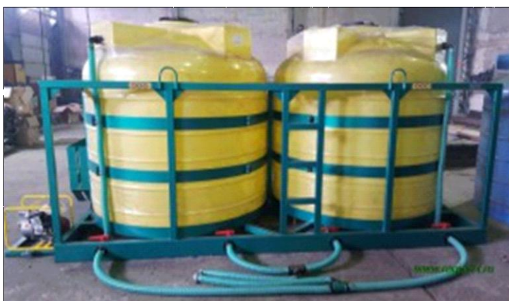
Смешиватель «Кассета» для жидких, сыпучих удобрений и с/х химии в жидкой среде.
