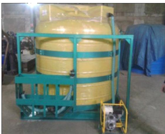
Смешиватель «Кассета» для жидких, сыпучих удобрений и с/х химии в жидкой среде.
