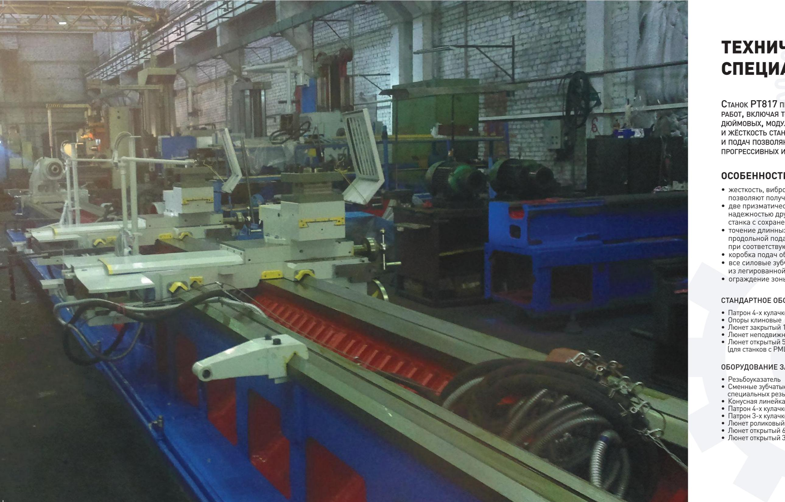
Станок РТ817 ПРЕДНАЗНАЧЕН ДЛЯ ВЫПОЛНЕНИЯ РАЗНООБРАЗНЫХ ТОКАРНЫХ РАБОТ, ВКЛЮЧАЯ ТОЧЕНИЕ КОНУСОВ И НАРЕЗАНИЕ РЕЗЬБ: МЕТРИЧЕСКИХ, ДЮЙМОВЫХ, МОДУЛЬНЫХ, ПИТЧЕВЫХ. Высокая мощность привода и жёсткость станка, широкий диапазон частот вращения шпинделя и подач позволяют полностью использовать возможности прогрессивных инструментов при обработке различных материалов.
