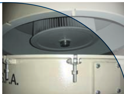
Particolare interno: separatore Details of the inside: separator
