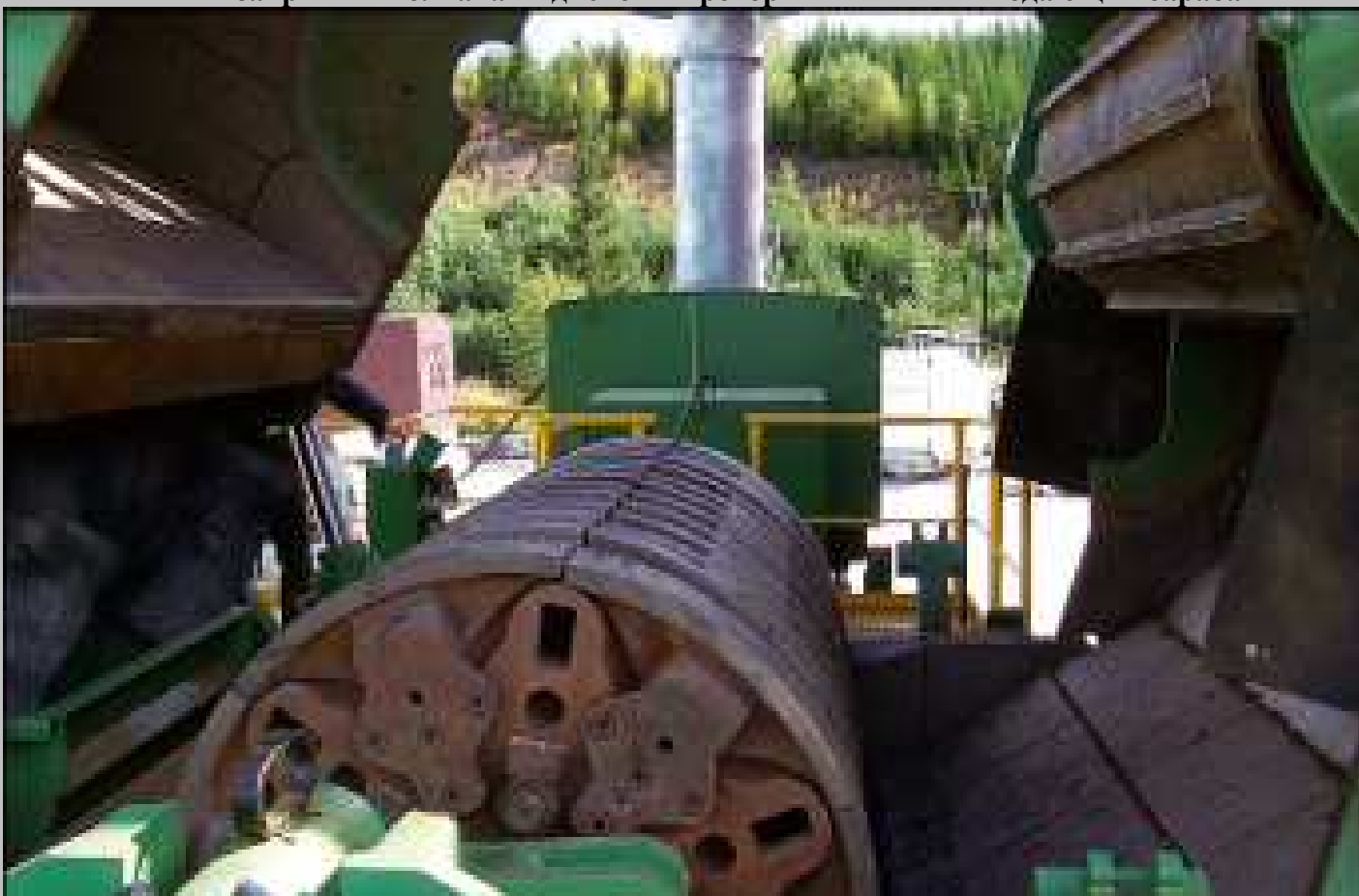
Верхняя секция шредера открыта гидроприводом: закрытый колпаками дисковый ротор
