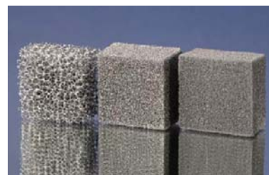
Рис. 1б. Образцы литой пены из нержавеющей стали 316L с размером ячейки 20, 45 и 60 ppi.
