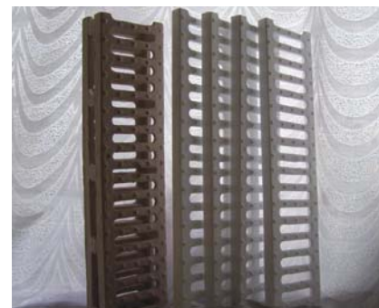
Рис. 7. Решетки ливнеприемников и канализационных систем, которые льют в стопках.
