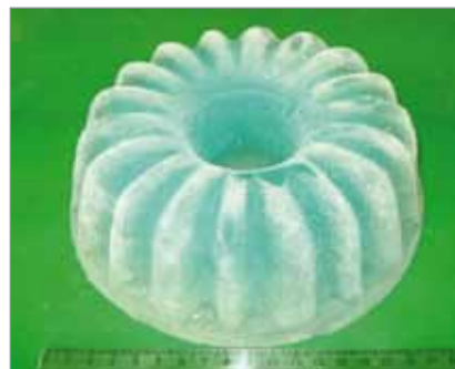
Фото 1, 2. Ледяные модели различных шестерен (лед с добавками до 10% связующего — жидкого стекла или крахмалита).
