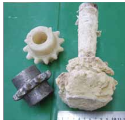
Фото 3. Отливка, ее ледяная модель и полученная по этой модели оболочковая форма.
