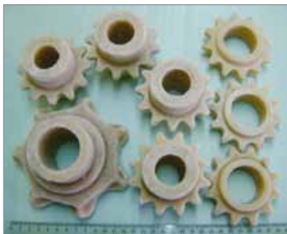
Фото 1, 2. Ледяные модели различных шестерен (лед с добавками до 10% связующего — жидкого стекла или крахмалита).
