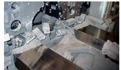
Супер Воздушные Ножи размером 3" (76мм) Модели 110003 в количестве 5 шт. сдувают стружку с оборудования, инструментов и направляющих при расточке.
