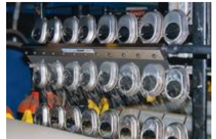
Модель 110024SS размером 24" (610мм) Супер Воздушного Ножа из нержавеющей стали высушивает поверхность болтов после электролитической полировальной ванны.
