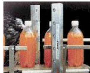
С помощью двух Супер Воздушных Ножей модели 110012 размером 12"(610мм) производится сушка быстро движущихся бутылок на конвейере перед нанесением этикеток.
