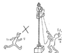
8. Поднимай грузы только вертикально во избежание раскачивания. Избегайте боковых усилий, то есть боковых нагрузок на корпус или на нижний блок.
