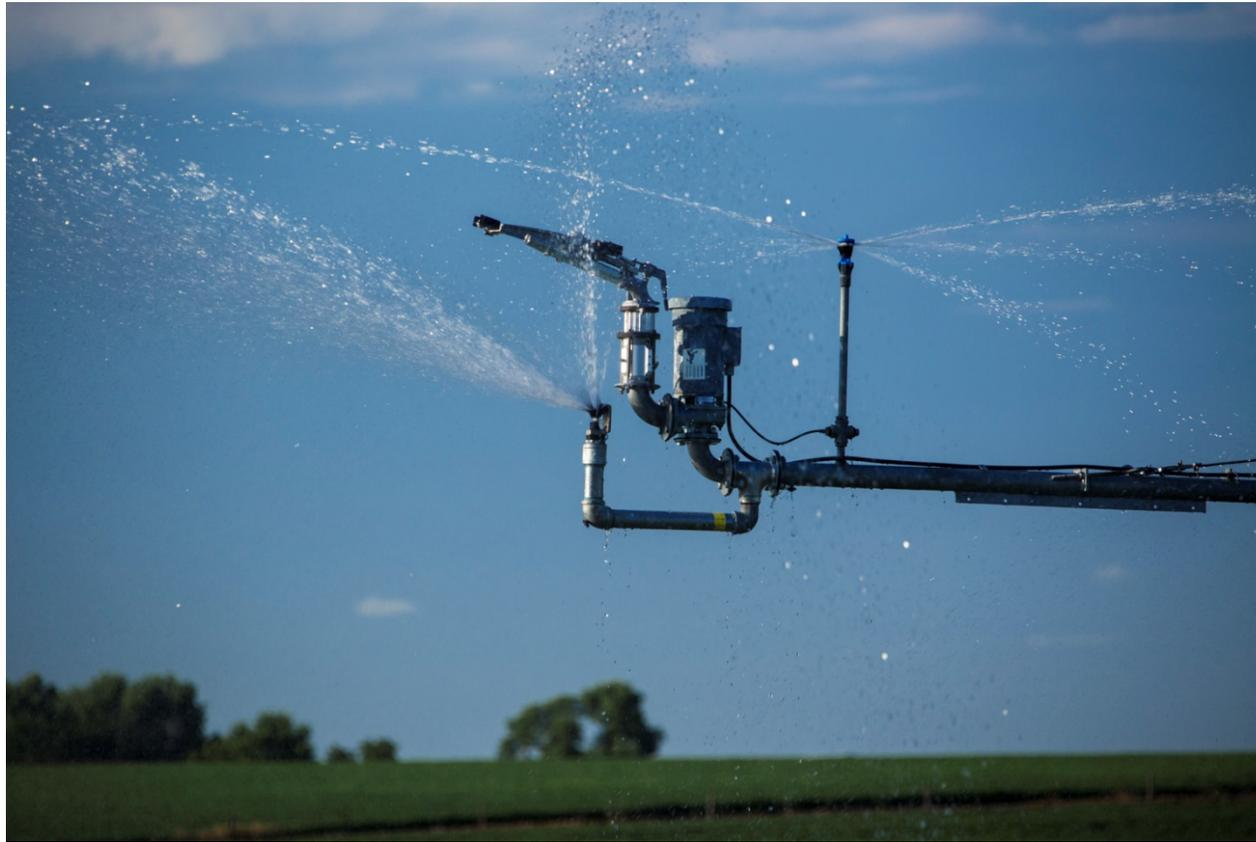
В концевой секции (18-20 м) устанавливается сплинклер, либо повышающий насос мощностью 2-5 л.с.
