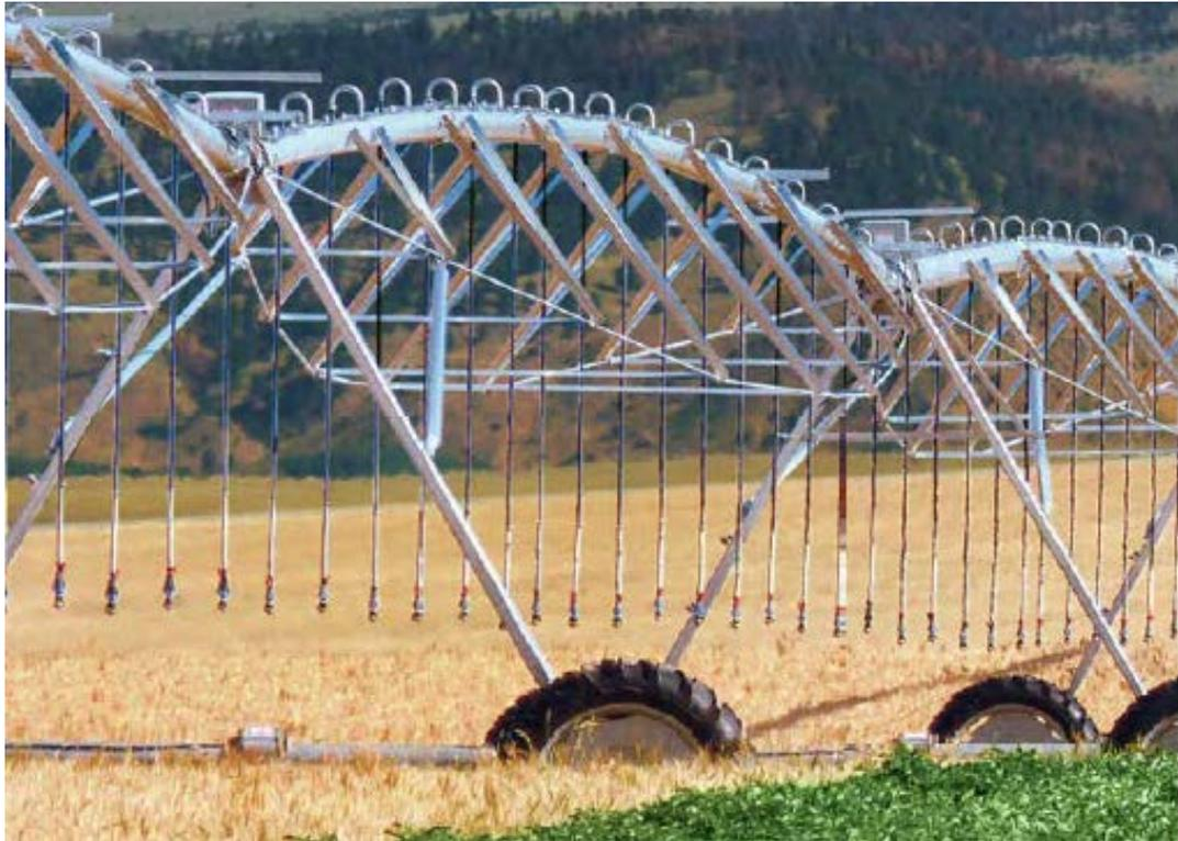
Пролеты Reinke с расстоянием между патрубками: стандарт **144 см** (101 см опция), обеспечивают равномерность полива **98% и более**.
