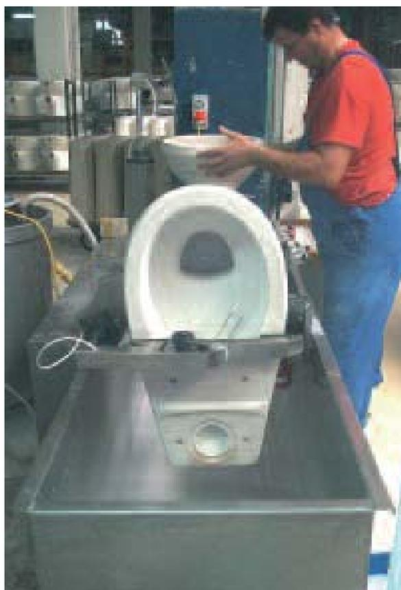
*Процесс загрузки изделий глазуровочной системы мод. "UPWARD2-EFS"*
