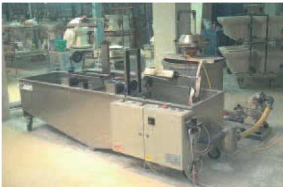
*Глазуровочная система мод. "UPWARD2-EFS" для сифонов и ободков унитаза*
