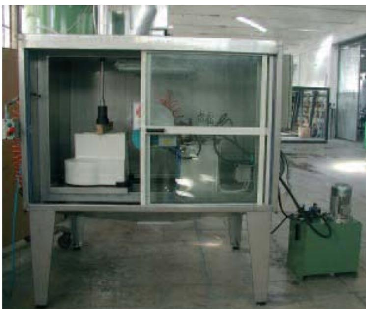
*Фрезерная машина для обожженных изделий*
