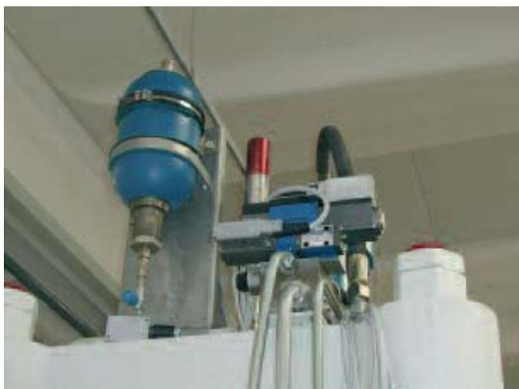
*Гидравлический блок управления мод. "НРСМ 100"*
