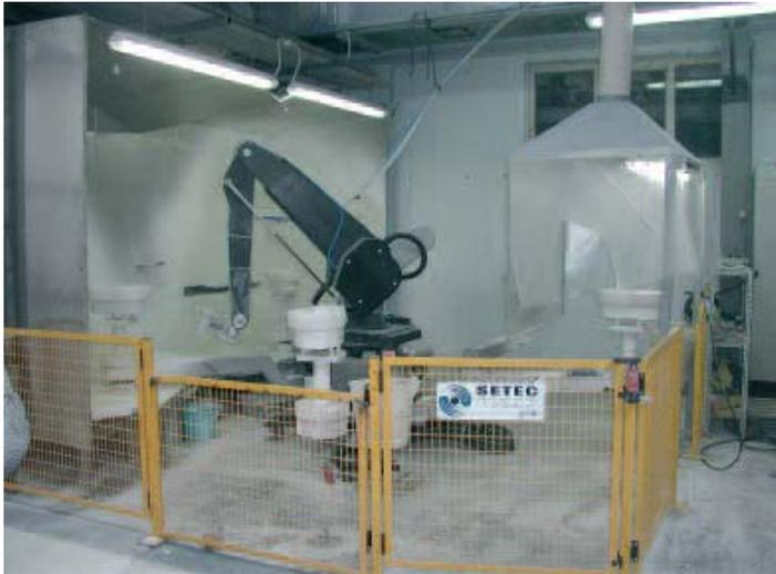
*Автоматическая глазурировочная машина карусельного типа с роботом мод. "S-2006"*
