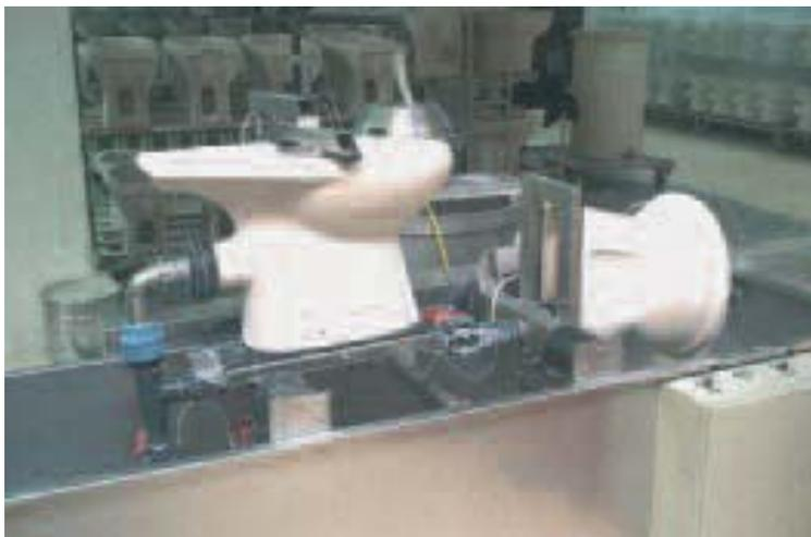
*Процесс глазурования системы мод. "UPWARD2-EFS"*
