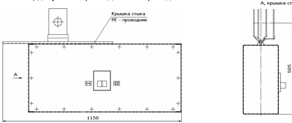
Рис. 2.14 Ответвительные секции с автоматическим выключателем.
