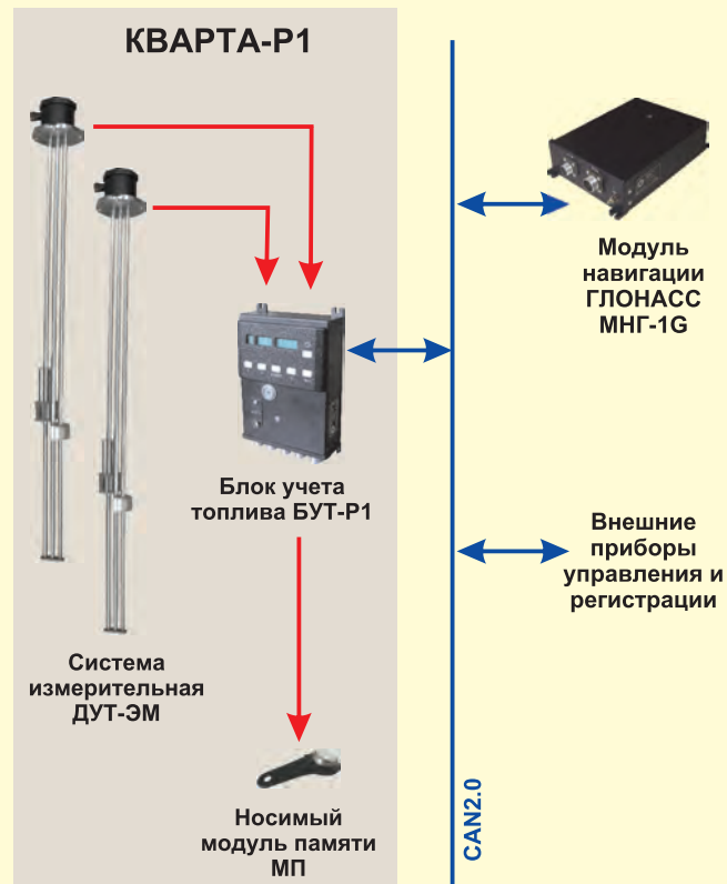
Схема работы комплекса измерительного количества топлива тепловозов КВАРТА-Р1
