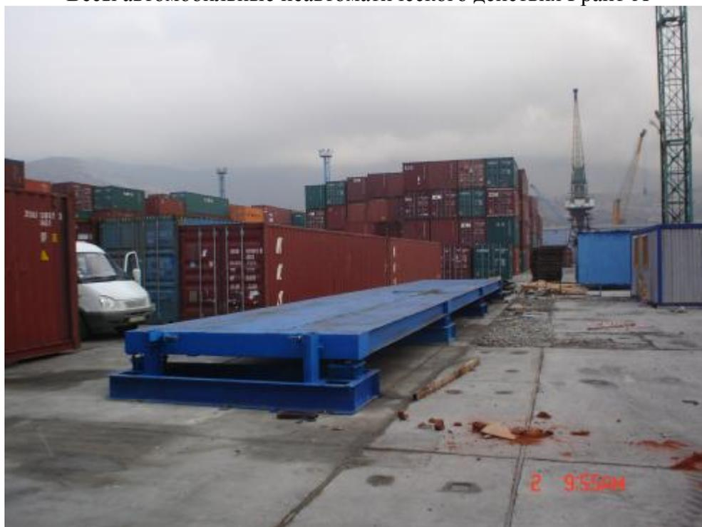
Весы автомобильные неавтоматического действия Грант-А-О
