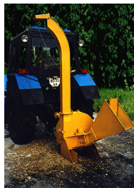
ИДО-150МН – навесное исполнение с ручной подачей древесины
