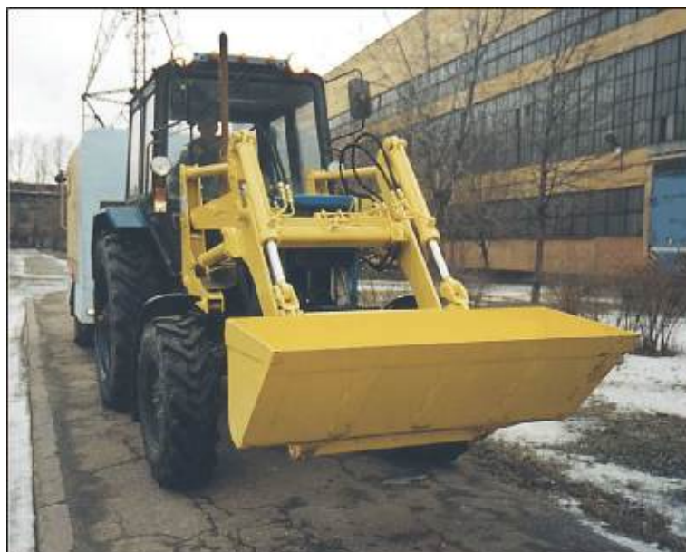
Фиг.7. Многофункциональный коммунальный трактор с погрузочным оборудованием ПФ-700
