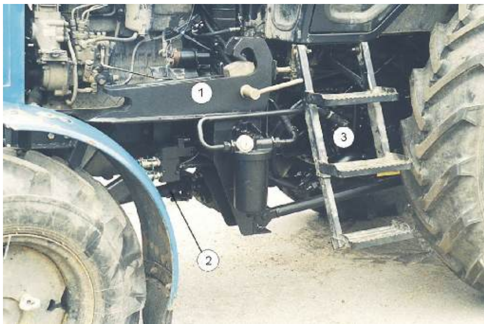
Фиг.1. Размещение элементов комплекта оборудования на многофункциональном коммунальном тракторе: 1 – рама, 2 – карданная передача переднего вала отбора мощности, 3 - гидростатический ходоуменьшитель.
