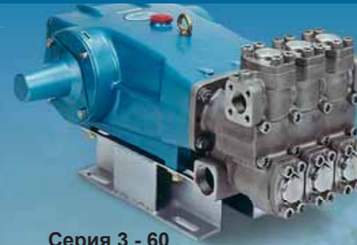
Серия 3 - 60 макс. давление: 7 - 345 бар макс. подача: 8,7 - 284 л/мин
