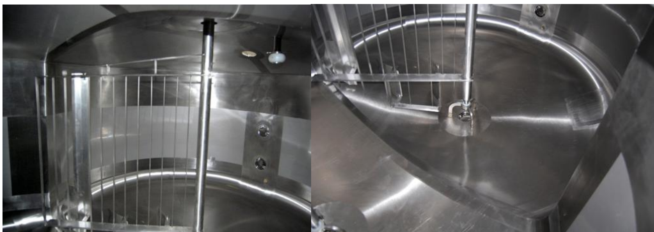
Внутренняя часть сыроизготовителя с торо сферическим дном
