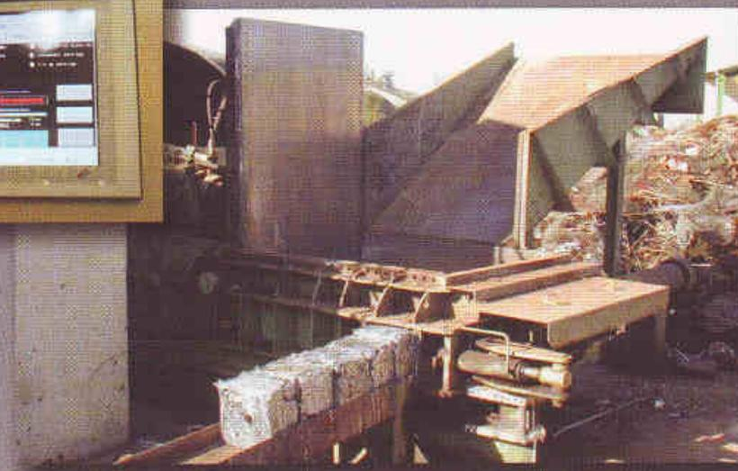
Применение : наш спектр прессов-пакетировщиков предназначен для переработки черного металлолома и цветных металлов. Сечения пакетов от 300 x 300 до 600 x 600, отвечающие всем потребностям. Пресс более малых размеров был разработан для переработки металлических банок.
