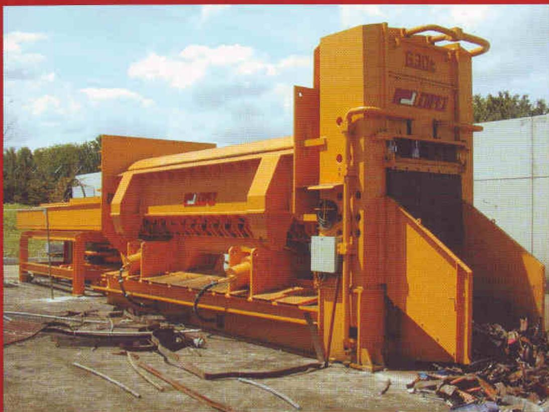
Модель CVV предоставляет все гарантии прочности и длительности срока эксплуатации больших пресс-ножниц COPEX; станина же ножниц подверглась нашим самым последним усовершенствованиям. Мощные быстродействующие ножницы и очень прочная пресс-камера: идеальный компромисс для достижения максимальной эффективности и надежности, производительность варьируется от 10 до 20 т/час в зависимости от типа продукта.
