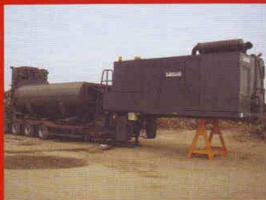
**Применение :** Гидравлические мобильные пресс-ножницы модели CVM были разработаны для компрессии и резания такого типа металлолома как профильные конструкции и трубы большой длины, спаянные структуры, платиновые и прочие элементы. Данный тип оборудования идеально подходит для переработки отходов, находящихся на разных площадках.
