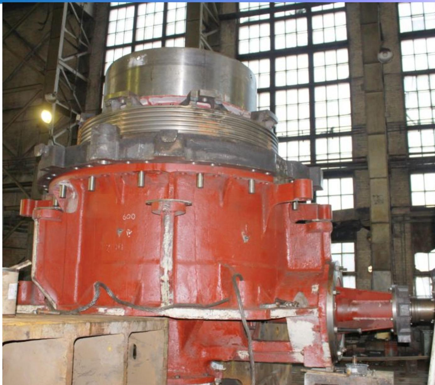
**Контрольная сборка конусной дробилки КМД-2200Т1-Д**
