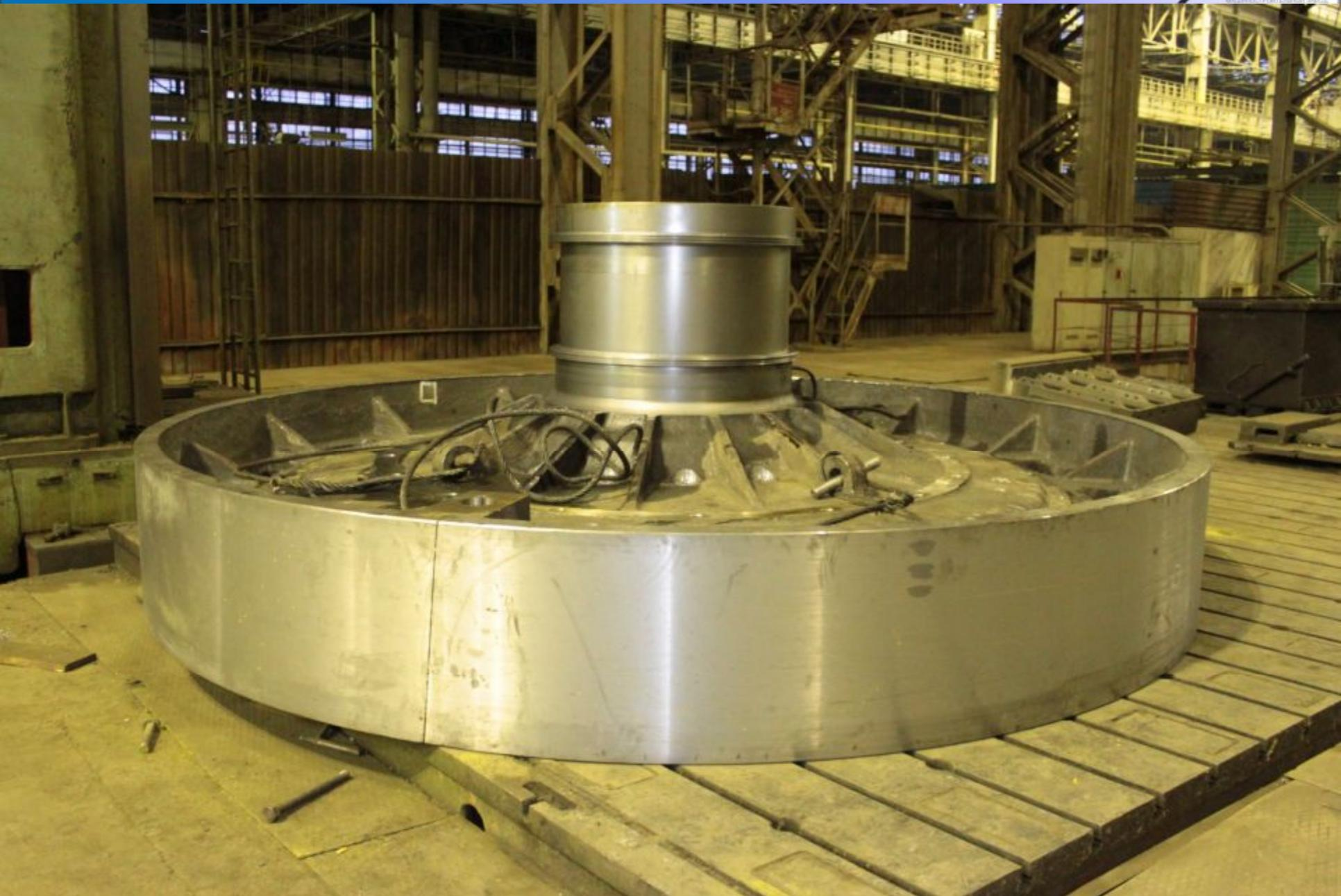
Заготовка венца зубчатого с крышкой разгрузочной мельницы 3,2х3,8
