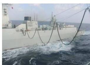
Применение в качестве гибких трубопроводов: для подачи под давлением бензина авиационного, бензина автомобильного, топлива реактивного, топлива дизельного, масла на нефтяной основе, смазки жидкостей, смазки солидола жирового, воды, жидкости охлаждающей низкозамерзающей, растворов неорганических кислот и щелочей, а также азотной кислоты. Может использоваться в морской среде для перекачки продуктов, снабжения топливом и жидкими грузами морских судов на ходу.
