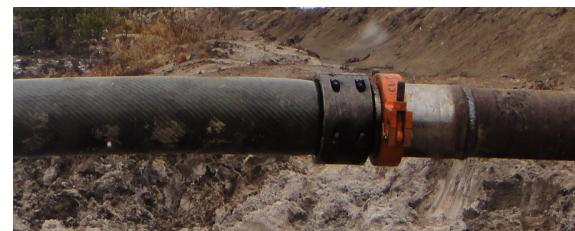
Все рукава могут комплектоваться быстроразъемными соединениями, обеспечивая тем самым скорость соединения между двумя рукавами и герметичность.
