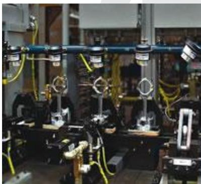
Пять Супер Воздушных Усилителей модели 120022 размером 2" (51мм) охлаждают поршни грузовика перед калибровкой.
