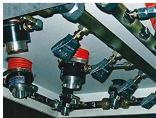
Модель 120022 размером 2" (51мм) Супер Усилителя Потока Воздуха и модель 1122 размером 2"(51 см) Супер Воздушного Сопла совместно обдувают коробку передач после обработки на станке.
