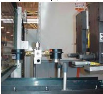
Модель 120022 размером 2" Супер Усилитель Потока Воздуха в количестве 2 шт. сушат небольшие детали,двигающиеся по конвейеру.
