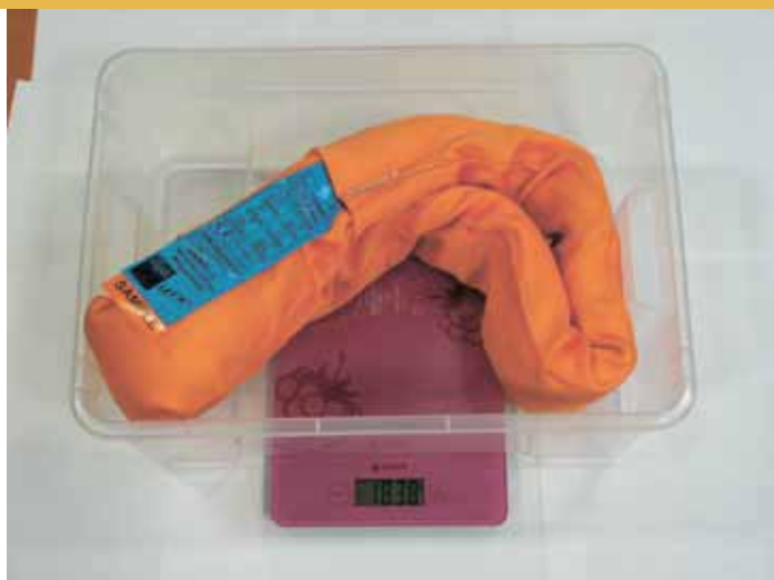
Строп из полиэстера Г/п: 15т, длина 0,5м Вес: 1838г
