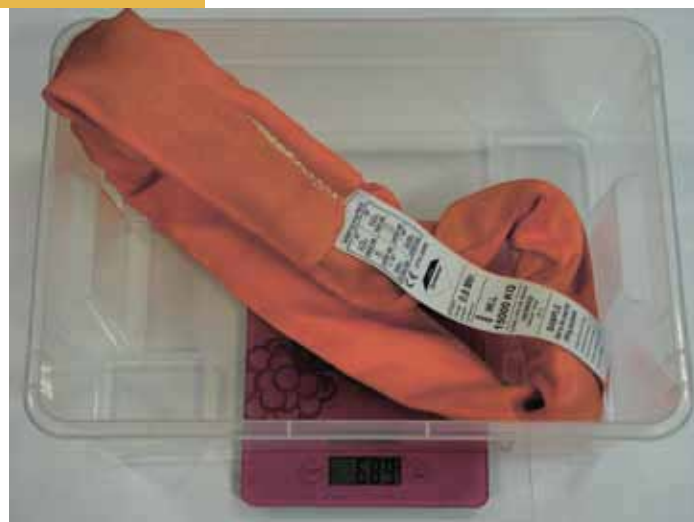
Строп из Дунеема Г/п: 15т, длина 0,5м Вес: 689г
