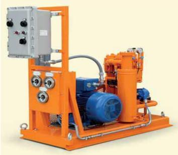
Компрессора подходят для перекачивания сжиженных углеводородов, хладагентов, аммиака, диметилового эфира, винилхлорида, воздуха, природного газа и ряд других технологических газов. Модельный ряд включает агрегаты производительностью от 32 до 108 м<sup>3</sup>/ч с рабочим давлением 25 бар.
