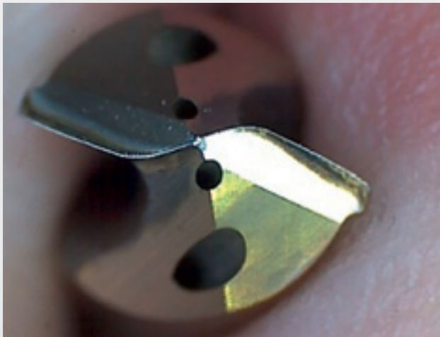
WEXO XS5DIKTAZ-HM nach ca. 1280 Bohrungen · after 1280 holes
