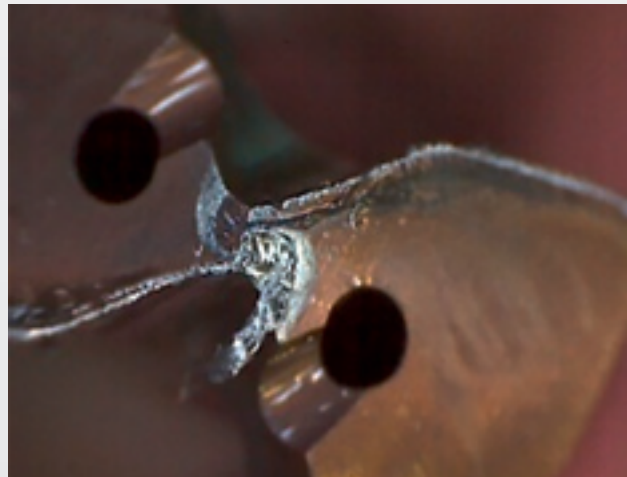
Wettbewerber · Competitor nach ca. 1280 Bohrungen · after 1280 holes
