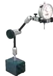
Оснащены мощными постоянными магнитами и могут быть легко установлены на любой металлической поверхности. Идеальны для всех случаев обработки, требующих магнитного притяжения вплоть до 60 кг. Для установки можно использовать опорную поверхность и одну боковую сторону. V-образный паз основания облегчает контакт с деталями, имеющими неровные поверхности. Все магнитные стойки поставляются без цифрового индикатора.
