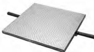
Изготовлены из высококачественного чугуна, имеют плиту значительной толщины и ребра жесткости на нижней стороне, придающие высокую жесткость при минимальных отклонениях. Поверхность плиты отшлифована. Высокая степень плоскостности и качества делает их идеальными базами для проведения измерительных операций.
