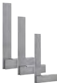
Изготовлены из закаленной пружинной стали и отшлифованы для обеспечения прямолинейности и перпендикулярности. Высокая точность: 16 микрометров для SS/A/4 и SS/A/6 и 24 микрометра для SS/A/12.
