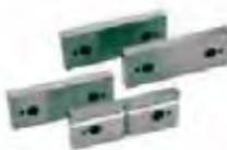
Сменные губки тисков поставляются как запасные детали, и легко устанавливаются на тиски. При повторной сборке губки могут потребовать шлифовки верхней поверхности для полного совпадения поверхностей. Компания Groz также предлагает специальные пары губок, одна из губок с вертикальными и горизонтальными V-образными пазами для удержания цилиндрических заготовок.
