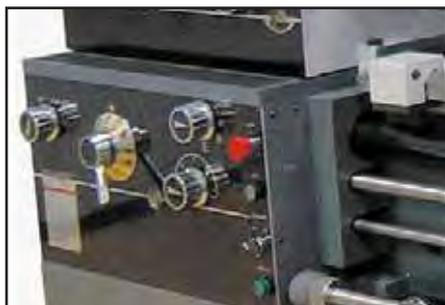
Полноразмерная коробка подач позволяет нарезать разную резьбу без замены шестерен
