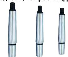
Изготавливаются из конструкционной легированной стали с поверхностной закалкой. Все оправки имеют поверхностную закалку до 54..58 HRC для повышенного сопротивления износу. Точная шлифовка с минимальным допуском и биением до 0,01 мм.
