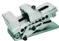
Изготавливаются из качественной инструментальной стали, закалены (55..60 HRC) и отпущены, а также установлены на прецизионно отшлифованное опорное основание. Все поверхности тисков отшлифованы для получения повышенной точности.
