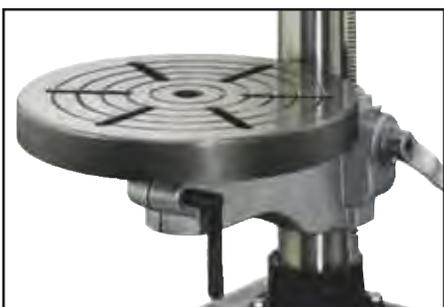
Круглый рабочий стол с механизмом подъёма-опускания
