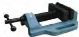
Предназначены для несложных сверлильных операций. Изготовлены из литейного чугуна. Неподвижная губка имеет горизонтальный и вертикальный V-образные пазы для крепления цилиндрических заготовок. Обе губки имеют уступы для зажима плоских и небольших по высоте деталей.
