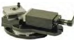
Поворотная губка имеет четыре поверхности: V-образный горизонтальный и вертикальные пазы, призматические и плоскость. Губку можно сменить, переставив сторону поворотной головки, и зафиксировать в нужном положении. Губки изготовлены из инструментальной стали, отшлифованы и закалены до 50..60 HRC.
