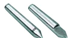
Выполнены по DIN 806. Изготовлены из высококачественной углеродистой стали. Рабочая кромка закалена до 60..63 HRC. Отшлифованы и имеют биение в пределах  $\pm 0,0025$  мм. Изготавливаются двух типов - Полный и Срезанный, оснащены твердосплавными вставками.
