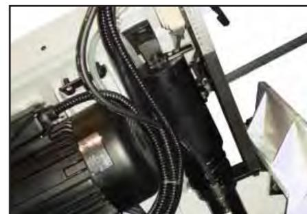
Гидроцилиндр подъема рамы с регулируемым концевым выключателем
