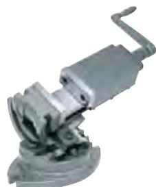
Изготовлены из мелкозернистого, высокопрочного, закаленного, литейного чугуна. Большая зона контакта прижимных элементов. Опорная поверхность имеет паз и прорези для фиксации на столе станка. Плоскостность опорной поверхности в пределах 0,03 мм (30 мкм) Закаленные (52..58 HRC) и отшлифованные губки из инструментальной стали с // 0,03 мм (30 мкм).
