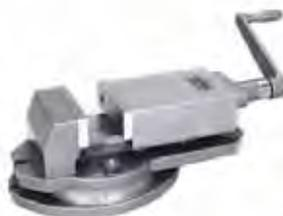
Применяются на фрезерных и координатно-расточных станках, при шлифовании и профилировании. Изготавливаются из мелкозернистого, закаленного литейного чугуна. Корпус тисков имеет высококачественное металлизированное покрытие, стойкое к царапинам и коррозии. Закаленные (52..58 HRC) и отшлифованные губки из инструментальной стали с параллельностью в пределах 0,03 мм (30 мкм). Шлифованная опорная поверхность.
