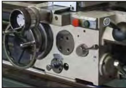
Управление продольной и поперечной подачей крестовым джойстиком с кнопкой ускоренного перемещения
