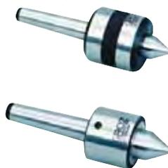
Изготавливаются из высококачественной стали, имеют закаленный корпус, с повышенной прочностью и жесткостью. Наконечник прецизионно отшлифован под угол 60° и закален до 60..63 HRC.
