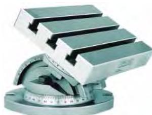
Изготовлены из прочного мелкозернистого чугуна с прецизионно отшлифованной опорной поверхностью, плоскостность в пределах 0,020 мм. Подходят для обработки в трех плоскостях при фрезеровании, сверлении, шлифовании, формовке и координатном растачивании. Перемещение в трех плоскостях позволяет отрегулировать стол под любым нужным углом.
