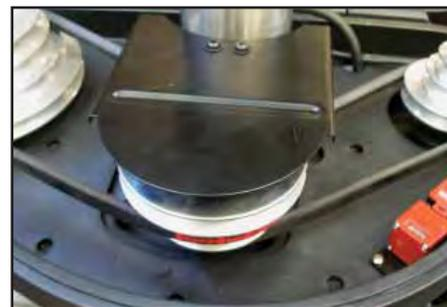
Ременная крышка с концевым выключателем
