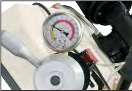
Тензомер контроля натяжения полотна
