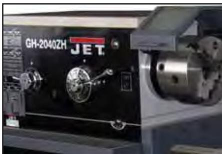
Патрон Ø250 мм с прямыми/обратными кулачками, отверстие шпинделя Ø80 мм
