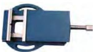
Предназначены для нагруженных операций. Изготовлены из мелкозернистого литейного чугуна. Имеют шлифованную опорную поверхность и направляющие, для гладкого и точного движения губок. Губки закалены и отшлифованы, на неподвижной губке имеется горизонтальный и вертикальный V-образные пазы, для удерживания цилиндрических заготовок.
