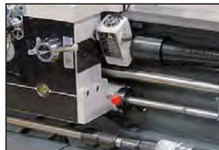
Вал управления с регулируемыми кулачками (отключение продольной подачи), лимб для нарезания резьбы
