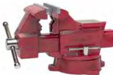
Прочная и долговечная конструкция из чугунного литья с наковальней, возможность поворота на 180°, два фиксирующих болта, вороток с безопасными наконечниками, губки из закаленной инструментальной стали, покрытие порошковой краской, встроенные губки для зажима труб различного диаметра. Красный цвет подходит идеально для автомастерских.
