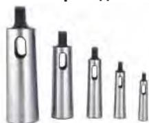
Выполнены по DIN 2185. Используются для присоединения инструмента с различными хвостовиками Морзе в шпиндели сверлильных станков. Изготовлены из конструкционной легированной стали с поверхностной закалкой. Отшлифованы по всей поверхности.
