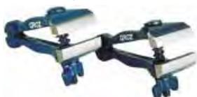
Изготавливаются из высококачественного чугуна. Губки фиксируются при помощи стопорного винта.
