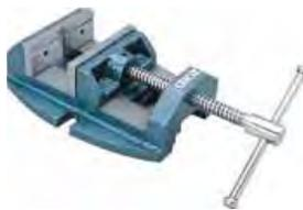
Изготавливаются из серого чугуна. Предназначены для точных работ, имеют шлифованное основание и направляющие. Горизонтальные и вертикальные V-образные канавки неподвижной губке позволяют надежно удерживать цилиндрические заготовки.
