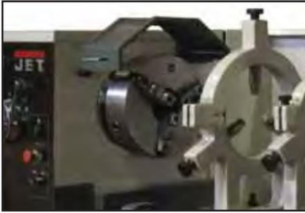
Патрон Ø325 мм с прямыми/обратными кулачками, отверстие шпинделя Ø105 мм
