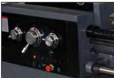
Полноразмерная коробка подач позволяет нарезать разную резьбу без замены шестерен
