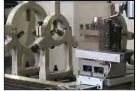
4-х позиционный резцедержатель с фиксатором, стандартные подвижный и неподвижный люнеты
