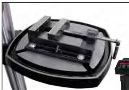
Вариант крепления тисков на столе
