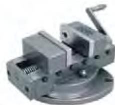
Предназначены для точного автоматического центрирования, для случаев, где одни и те же операции выполняются деталях разного размера. Изготовлены из плотного высококовкого закаленного вторичного чугуна. Профрезерованный паз основания тисков позволяет правильно направлять их на станке.
