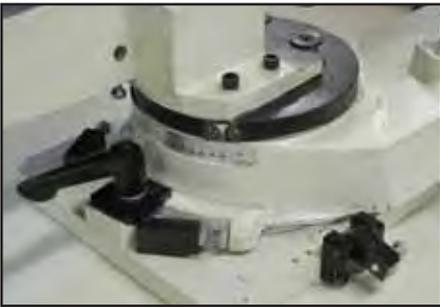
Регулируемые упоры углов положения пильной рамы
