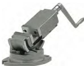
Изготовлены из мелкозернистого, высокопрочного, закаленного, литейного чугуна. Большая зона контакта прижимных элементов. Опорная поверхность имеет паз и прорези для фиксации на столе станка. Плоскостность опорной поверхности в пределах 0,03 мм (30 мкм) Закаленные (52..58 HRC) и отшлифованные губки из инструментальной стали с // 0,03 мм (30 мкм).
