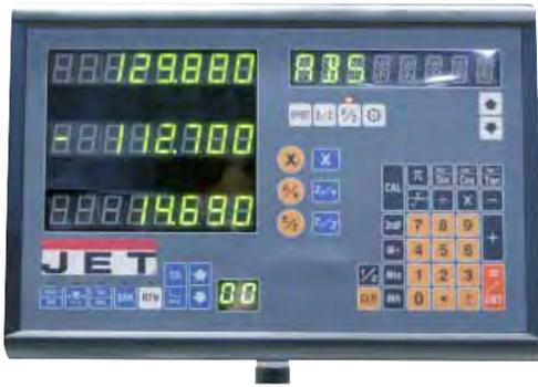
УЦИ, устройства цифровой индикации, предназначены для оснащения универсальных металлорежущих станков (токарных, фрезерных, сверлильных и т.п.) с целью повышения производительности работы, повышения точностных характеристик и выполнения сложных операций.
