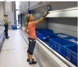
мости безопасно хранить обширный ассортимент использующихся на производстве ценных деталей и регулярно расширять их номенклатуру руководство предприятия прибегло к помощи современных автоматизированных систем хранения Kardex Shuttle XP. Так, на «Экре» появилось семь автоматизированных систем лифтового типа для складирования, загрузки и транспортировки груза с электронной системой управления: шесть из
