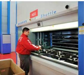
Кагdex Remstar Shuttle XP — интеллектуальные автоматизированные складские лифтовые системы, обеспечивающие максимальную плотность хранения на минимальной площади. Эти устройства представляют собой высотные конструкции, в основу которых заложен принцип наращивания вертикальных блоков, а каждая единица груза управляется с помощью контролируемого компьютером манипулятора, который доставляет необходимый поддон к месту выгрузки, а затем возвращается в свободную ячейку.
