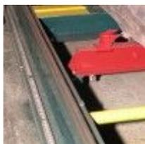
Зажимы позволяют надежно удерживать пиловочник на раме станка. За счет неподвижного закрепления бревна обеспечивается отсутствие дополнительных нагрузок, и как следствие износа, на направляющих станка.
