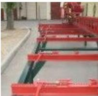
Зажимы позволяют надежно удерживать пиловочник на станине станка. За счет неподвижного закрепления бревна обеспечивается отсутствие дополнительных нагрузок и вибраций.
