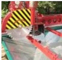
Механизм поштучной выдачи бревен на станок
