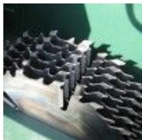
Шпиндель пильного узла собран на высокоточных подшипниках и исключают биение пильного вала. Конструкция пильного узла позволяет устанавливать на валу до 10 дисковых пил.
