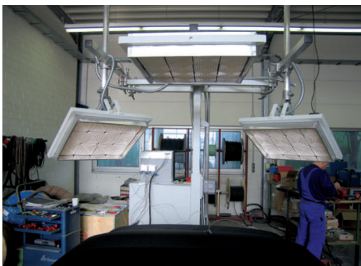
Мобильная конструкция для сушки верха кабриолет-автомобиля
