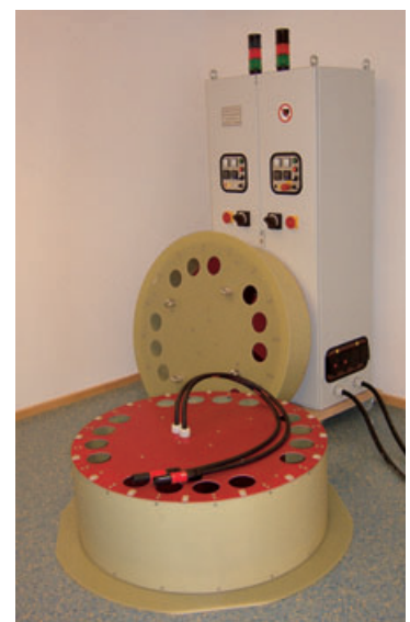
Индукционная установка с воздушным охлаждением для стыковки/расцепления горячих прессовых соединений и для проведения термобработки деталей.
