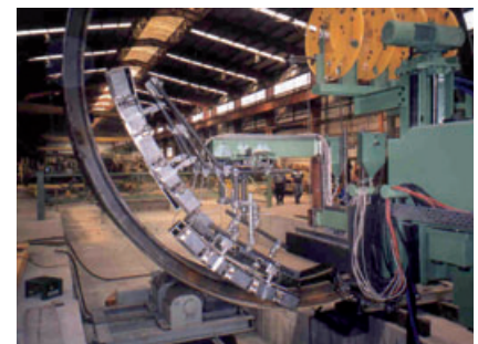
Предварительный нагрев частей подводной лодки инфракрасными электронагревателями
