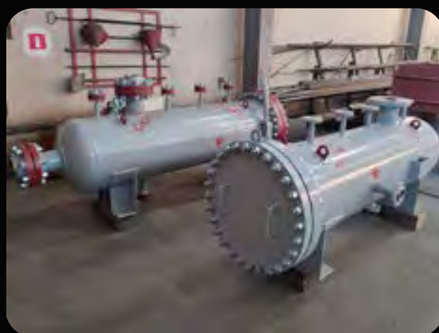
СЕПАРАТОРЫ СГВ для комплектации поршневой компрессорной установки по заказу АО «РариТЭК Холдинг»
